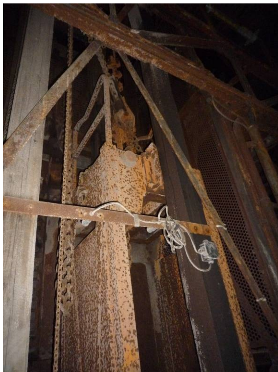
Obr. č. 19: Těžná klec malého oddělení.
