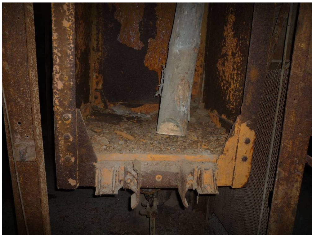
Obr. č. 20: Dno těžné klece malého oddělení.
