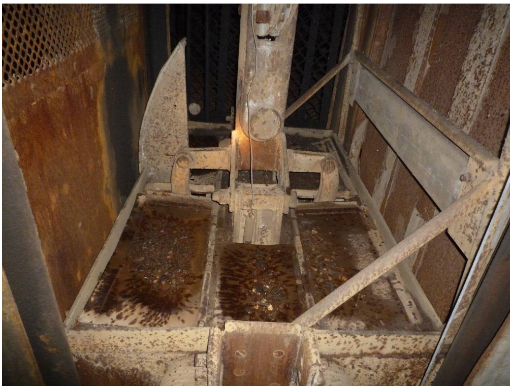
Obr. č. 17: Pohled na zavěšení těžné klece.
